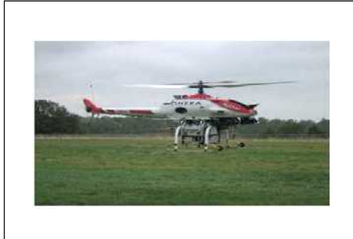
Figure. I.11 : Drone de surveillance RESSAC de l'ONERA [8].
