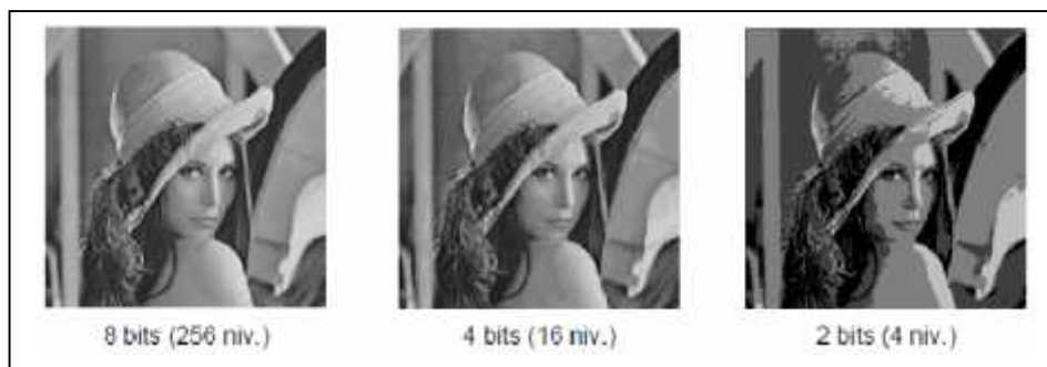
Figure .II.5 : Effets de la quantification à l'acquisition.
