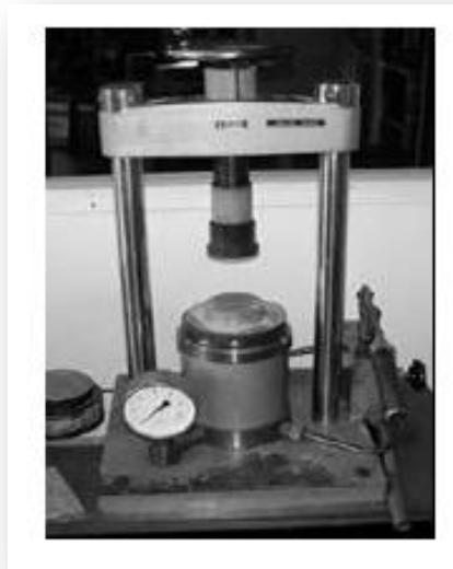
Figure (III.1): La presse hydrostatique utilisée pour la préparation des pastilles.
