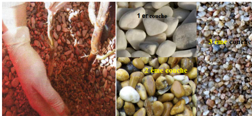
Figure .III.3. Disposition du gravier dans les filtres d'essai
