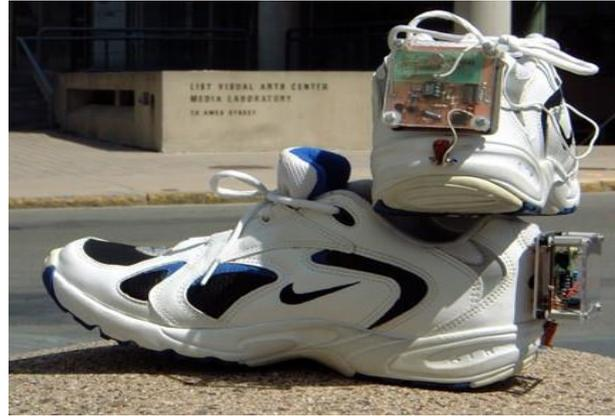
**Figure I.17:** Chaussure piézoélectrique [15]
