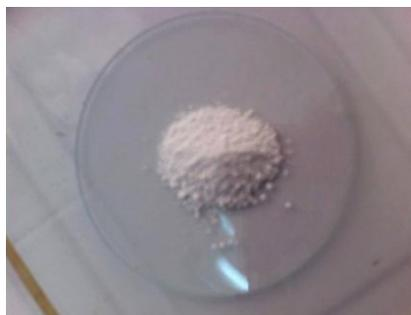
**Figure III.3** : Dioxyde de Zirconium ZrO<sub>2</sub>
