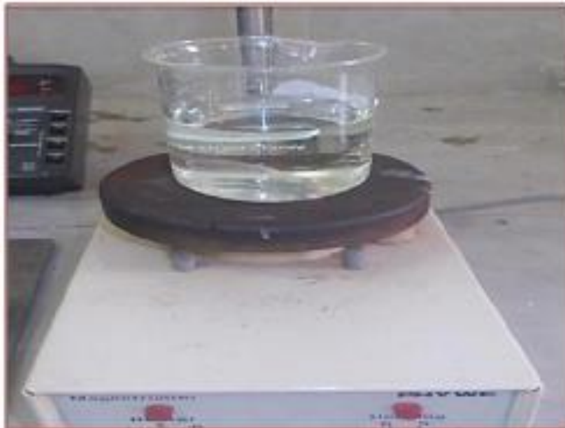
Fig. III.3 Schéma de montage de décapage chimique.
