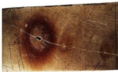
Fig I.3: Corrosion par piqûres [6].
