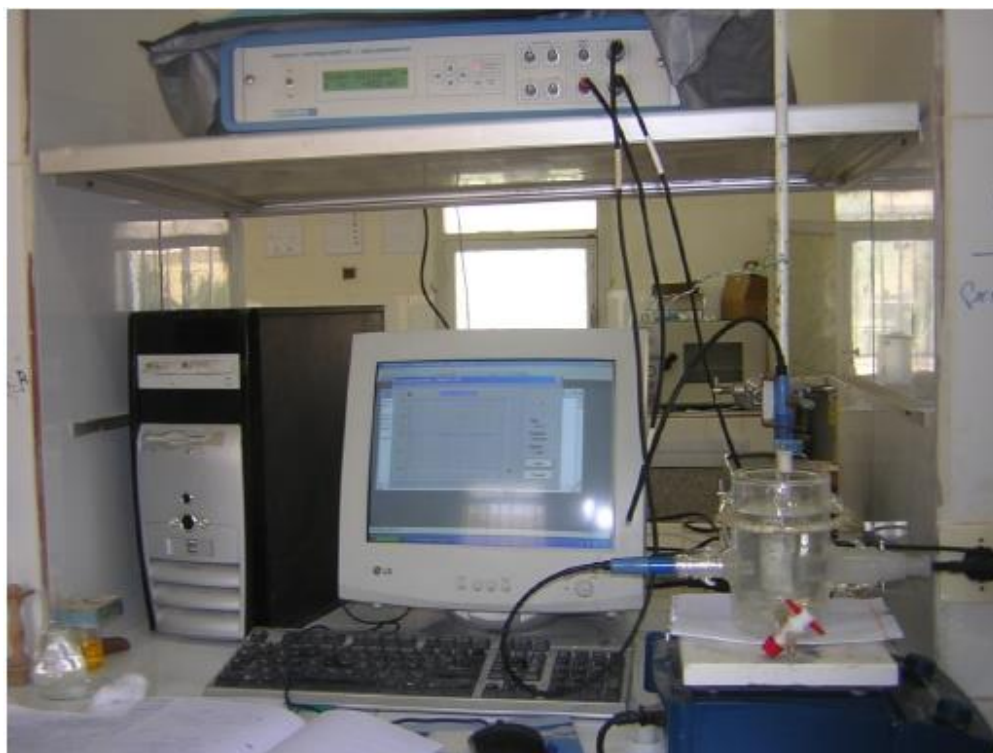
Fig III.7. Montage potentionstatique pour mesures électrochimiques
