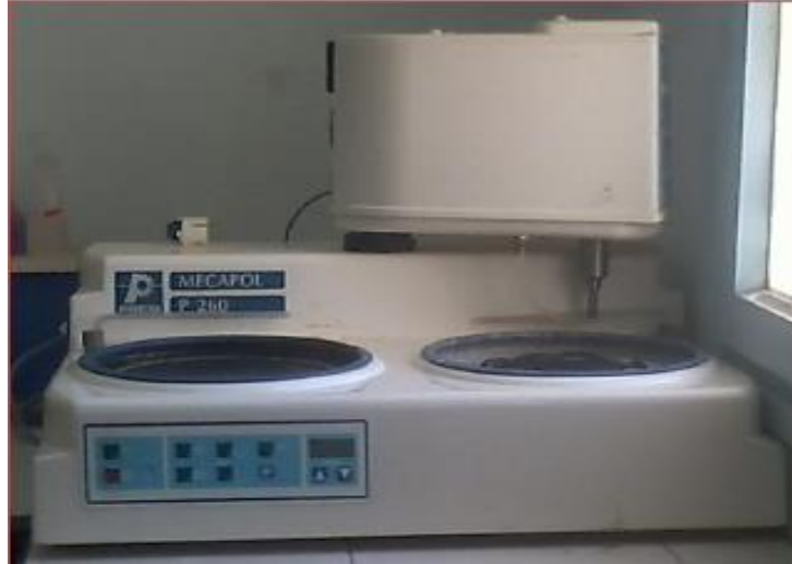
Fig. III.1 Schéma de polisseuse utilisé dans le polissage mécanique.
