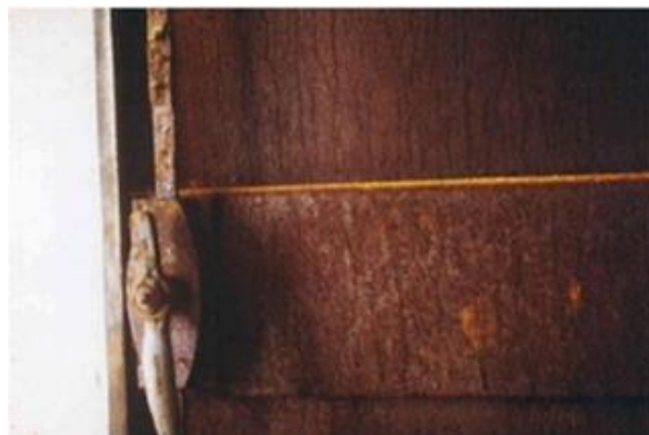
Fig I.1 : Corrosion uniforme et corrosion localisée [1].
