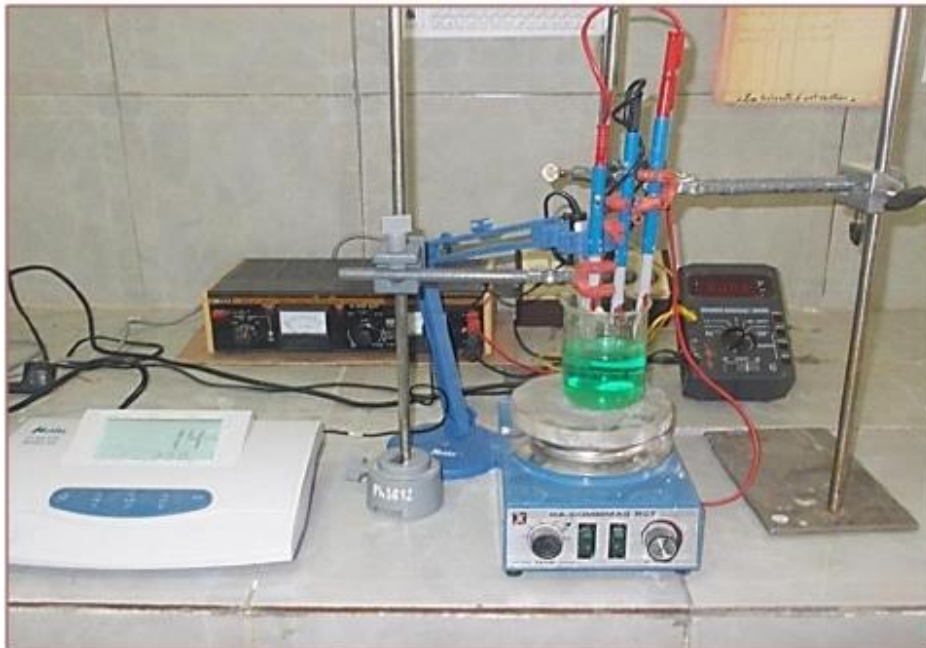
Fig. III.4 Schéma de montage d'électrodeposition.
