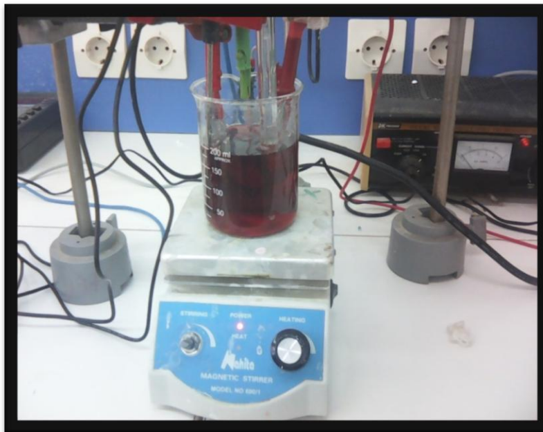
Fig(III.7) : montage de bain de zinc-cobalt.
