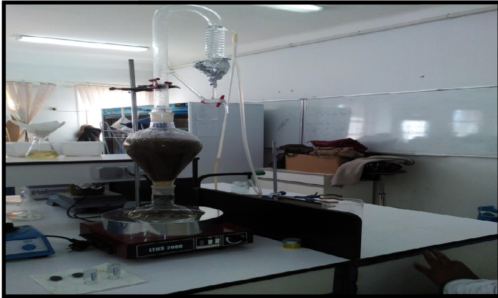
Fig.7 : Extraction par hydrodistillation ce type clevenger
