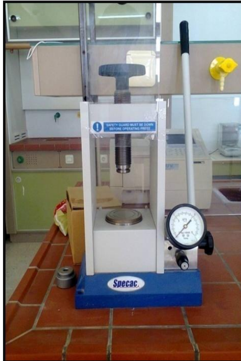
Figure III.10: Presse hydrostatique utilisée pour la préparation des pastilles
