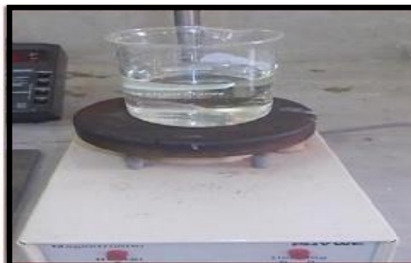
Fig. (III.4) : Schéma de montage de décapage chimique
