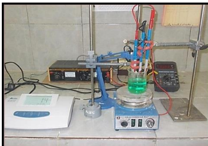
Fig. (III.5) : Schéma de montage d'électrodeposition
