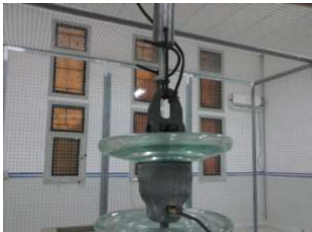
Photo.III. 3.a Photo .a Modèle d'un isolateur réel 175 CTV
