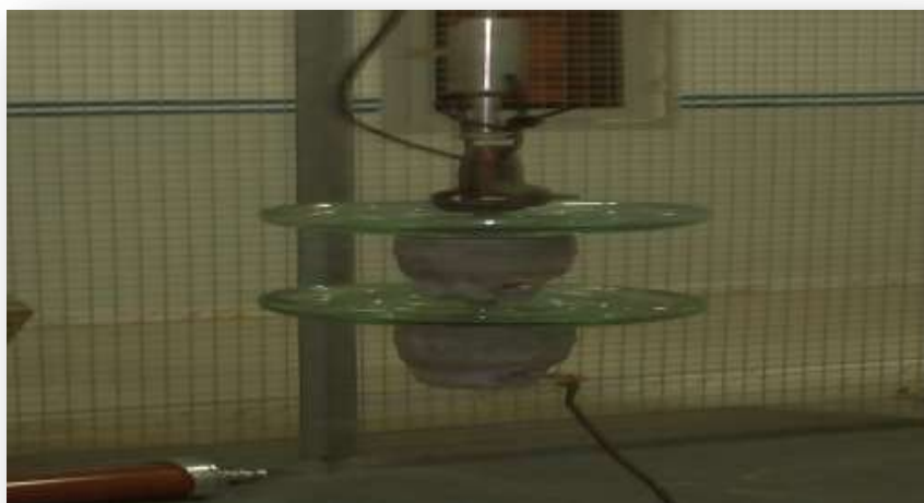
Photo.III. 3.b Modèle d'une chaîne d'isolateur réel 175 CTV
