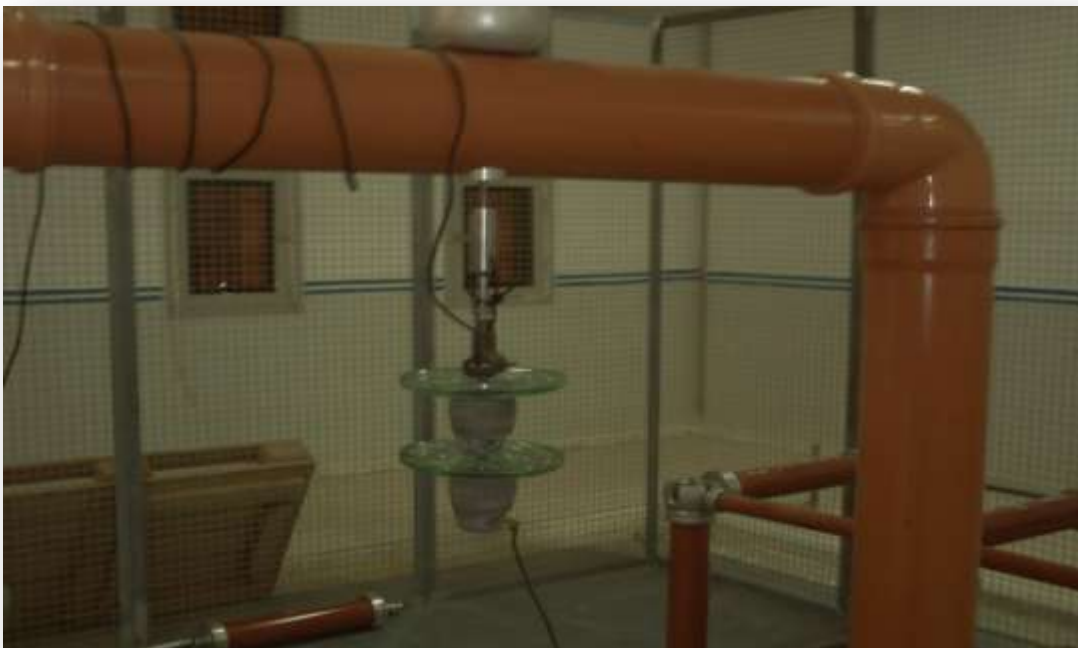
Photo.III. 1. du circuit d'essai à fréquence industrielle (Modèle réel).
