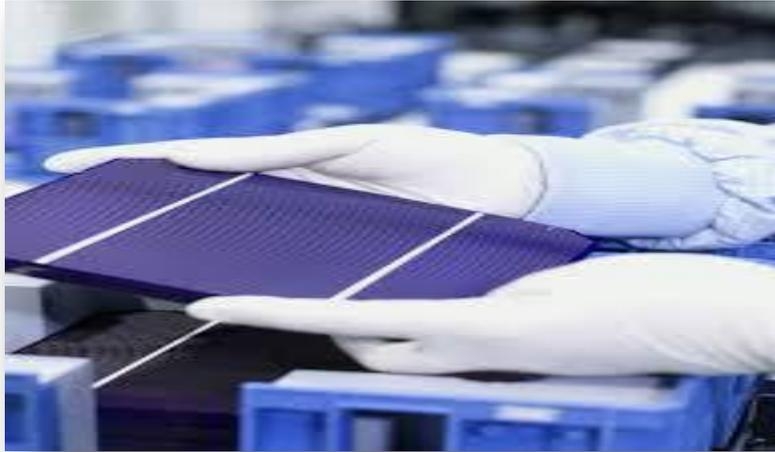
Figure(II.7) : Une cellule Photovoltaïque
