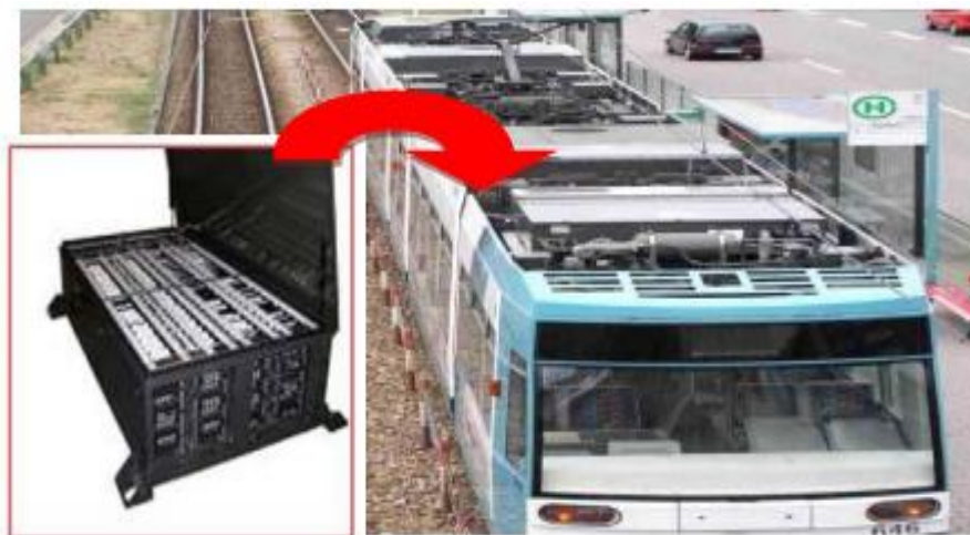
(Fig.1. 4) : Système MITRAC utilisant les super condensateurs pour le stockage de l'énergie
