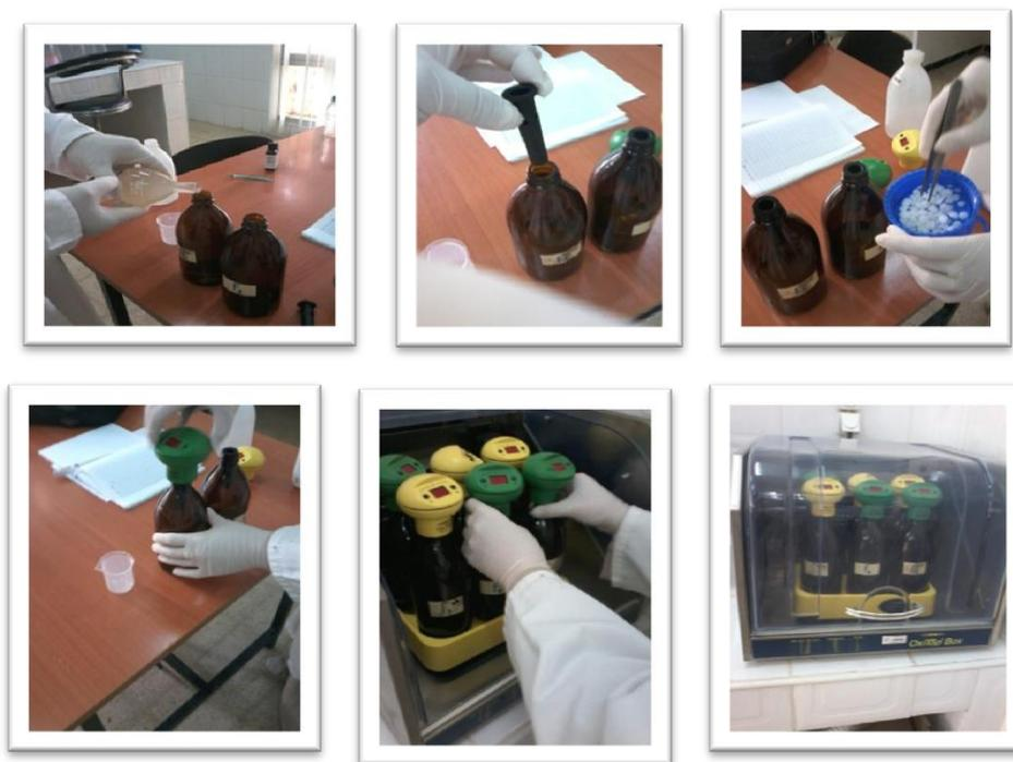
*Figure.3.16. Méthode d'analyse de DBO<sub>5</sub>.*
