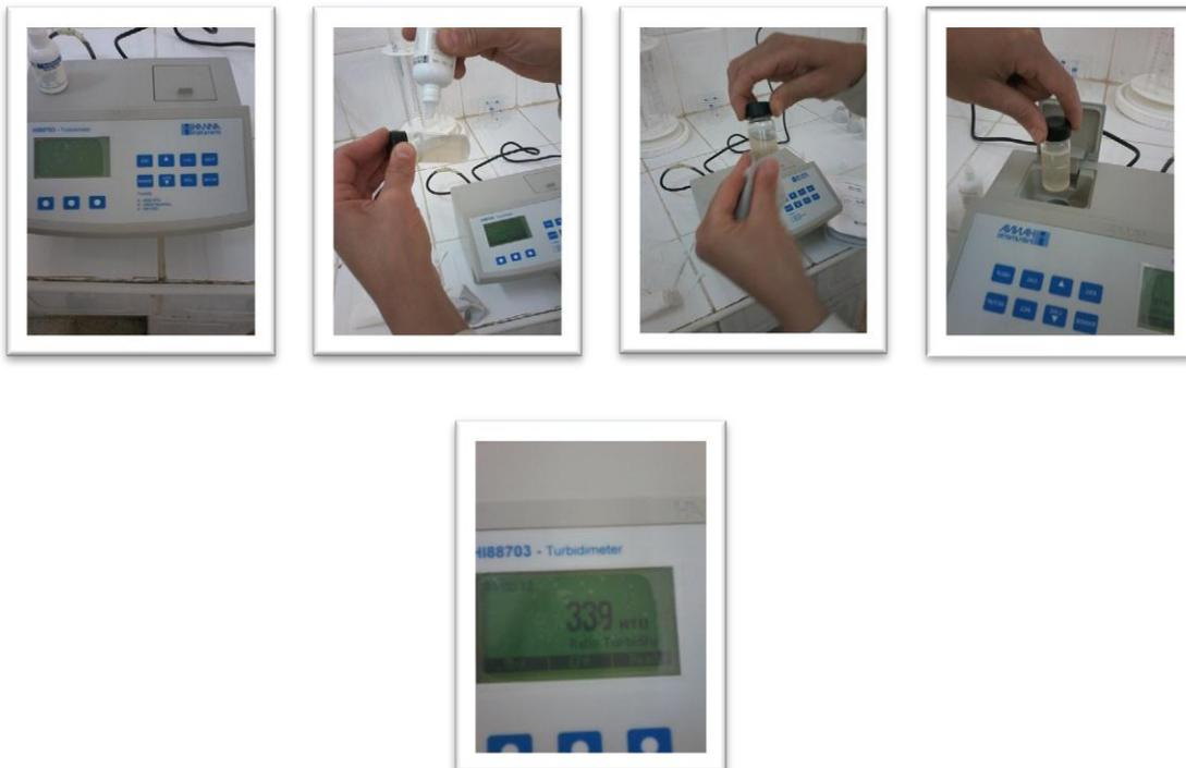
*Figure.3.9. Méthode d'analyse de turbidité.*
