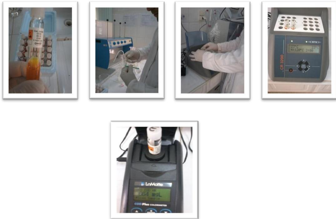
*Figure.3.14. Méthodes de mesure de la DCO*
