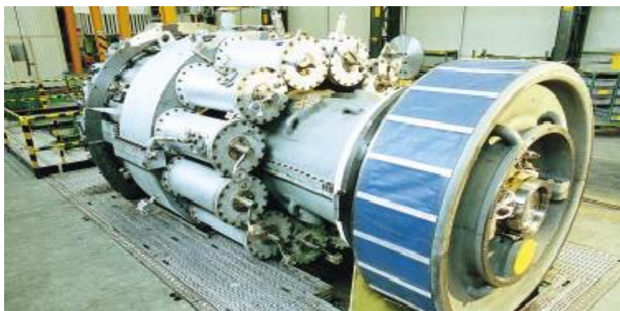
Figure(II-1) : La turbine à gaz MS 5002C.
