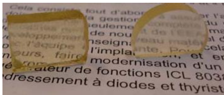
Figure 6 : photos du verre 80 \text{ Sb}_2\text{O}_3 \text{ 10 CdCl}_2 \text{ 10SrCl}_2
