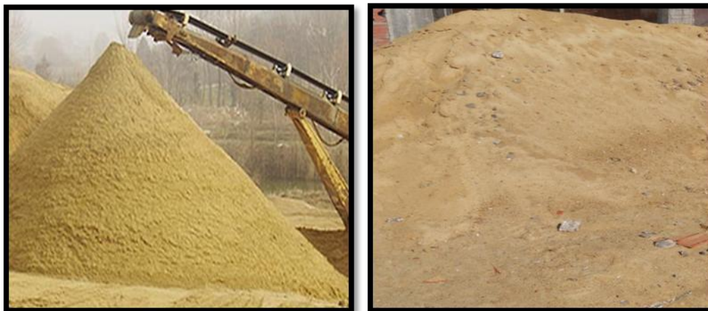
Fig.30: Le Sable stocké sur chantier de qualité acceptable
