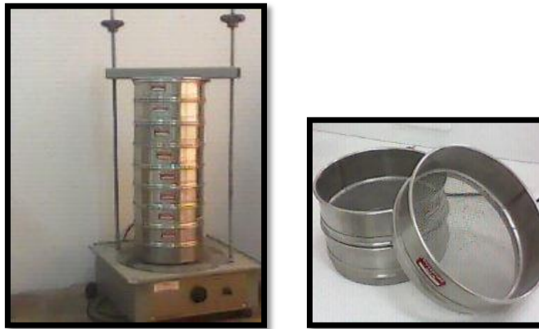
Photos II.1: Tamis et tamiseur électrique.
