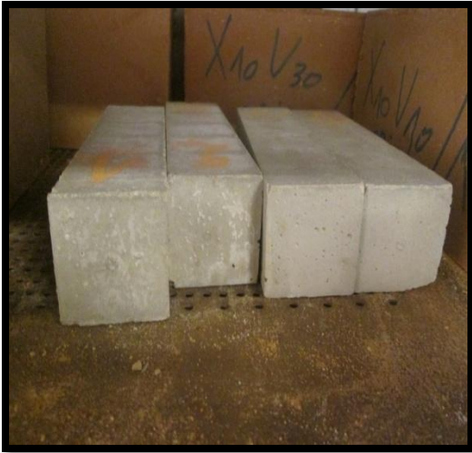
A : Stabilisation du poids par étuvage
