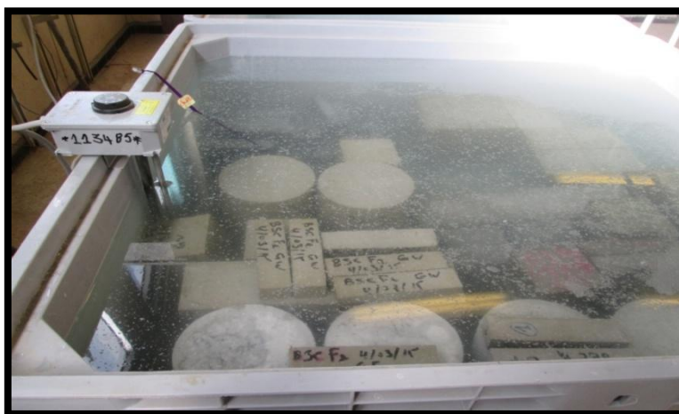
Photos II.15 : Des éprouvettes dans un bac de conservation.
