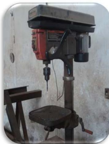
**Fig.16** : perceuse avec courroie
