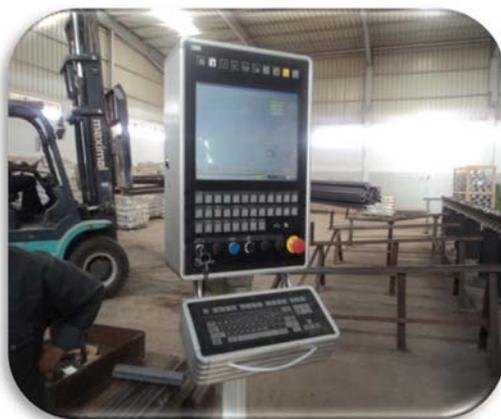
**Fig.13** : Télécommande et programmeur de la machine HP16T6
