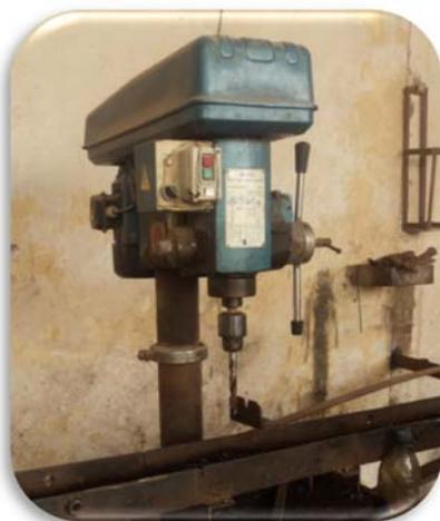
**Fig.15** : perceuse avec courroie manuelle pour grands diamètres
