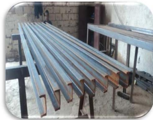
**Fig.40** :Les lisses de bardage (chantier 1)
