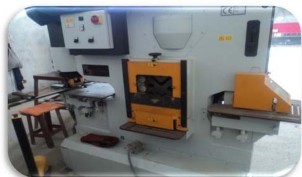
**Fig.10 :** Cisaille poinçonneuse -ST80-
