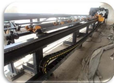
**Fig.12** : Cisaille poinçonneuse HP 16.T.6 (atelier 1)
