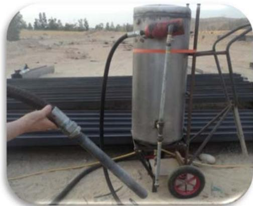
**Fig.23** : Machine pour le Sablage (chantier 3)
