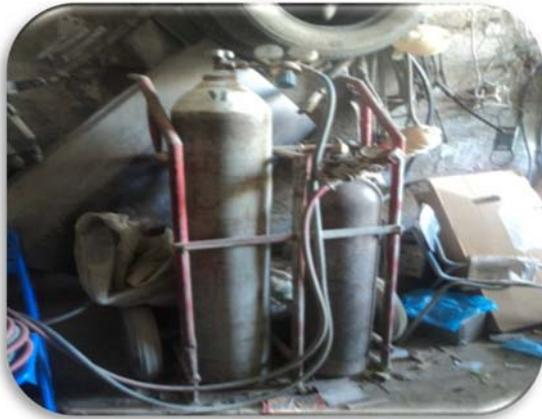
**Fig.24** : bouteilles d'oxygène et d'acétylène pour soudage au gaz et oxycoupage
