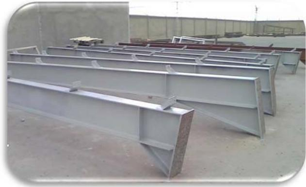
**Fig.42** : les traverses avant le montage (chantier 1)
