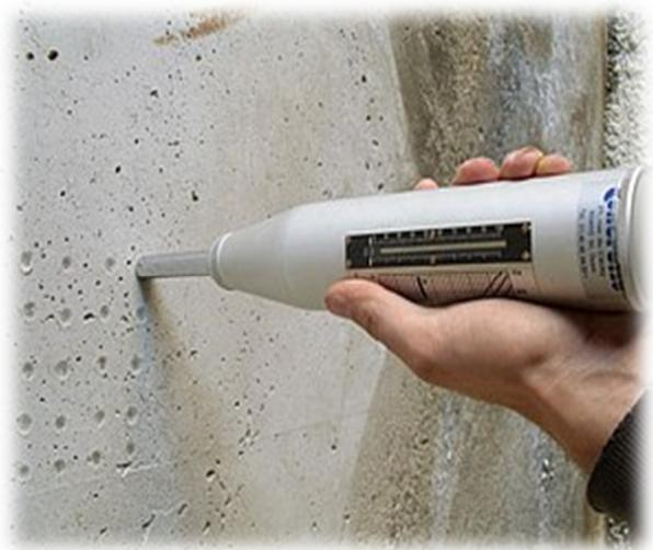
Photo.37. Mesure de la résistance sur l'élément scléromètre .
