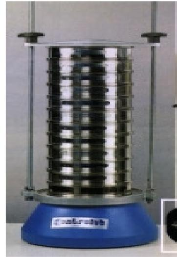
Photo.13. Appareil de tamiseuse
