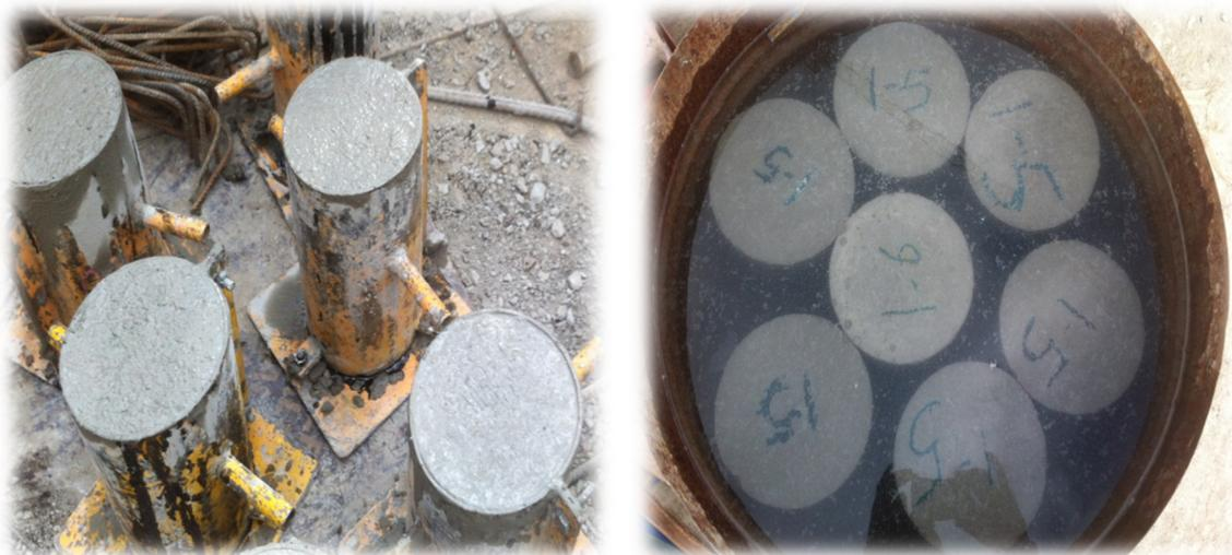
Photo.17. Les éprouvettes préparées sur chantier pour l'essai de contrôle
