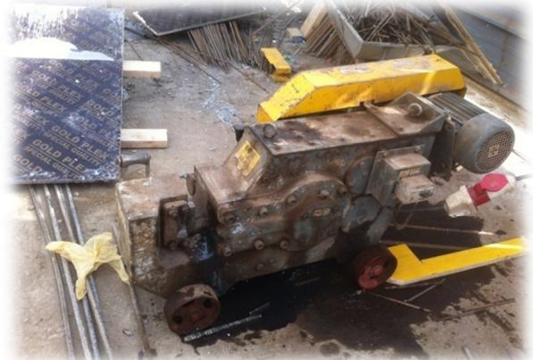
Photo.3. Appareils de coupage et de façonnage
