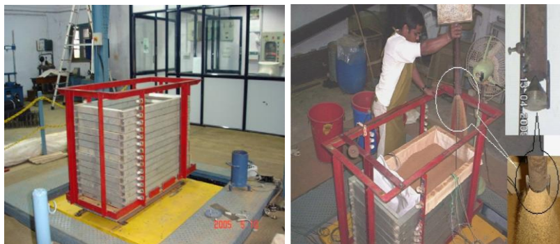
Fig.3.21. Test d’un mur sur une table à secousse, (G.madhavi et A.M. Krishna .2008).
