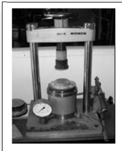
Figure II.3: La presse hydrostatique utilisée pour la préparation des pastilles
