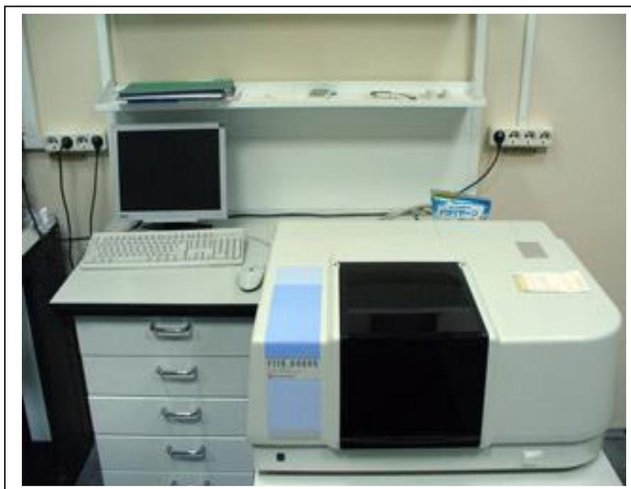
**Figure III.20:** spectrophotomètre de type Shimadzu FTIR-8400S PC
