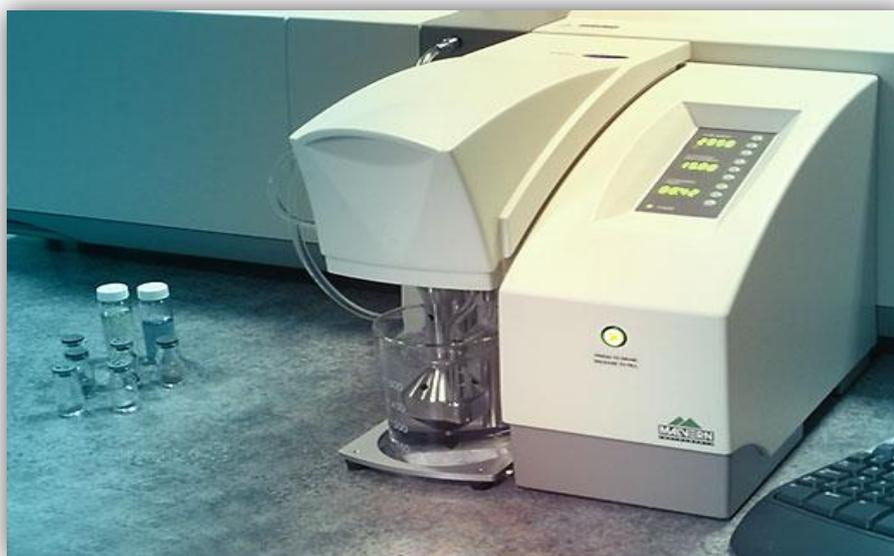
**Figure II.16. Granulomètre laser**
