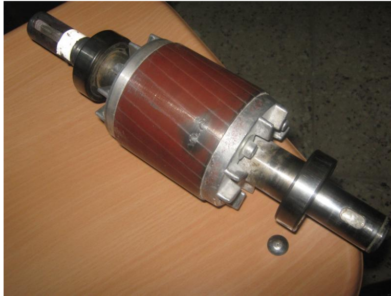
Figure III.8. Rotor de la machine 1.1 kW avec deux barres cassées.
