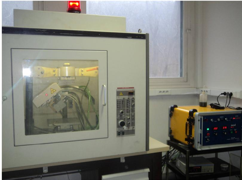
**Figure IV.6 :** Appareillage de type Set-X pour mesurer les contraintes résiduelles
