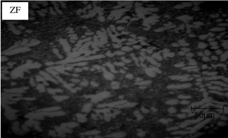
Figure V.16 : Microstructures des zones (MB, ZAT, ZF) du joint soudé traité thermiquement à 200°C pendant 1heure
