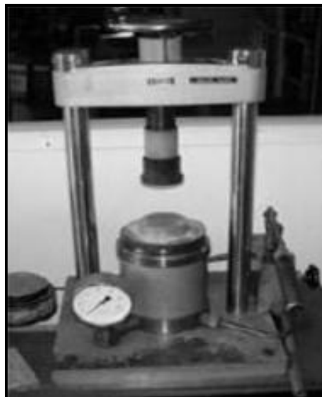
Figure II.06: La presse hydrostatique utilisée pour la préparation des pastilles [8].
