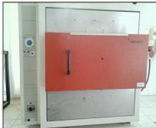
Figure III.10 : Four pour faire le traitement thermique (calcination).
