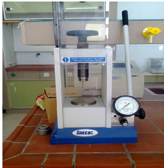
Figure III.9: Presse hydrostatique utilisée pour la préparation des pastilles.
