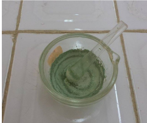
Figure III.8: Broyage pendant 6 heures.
