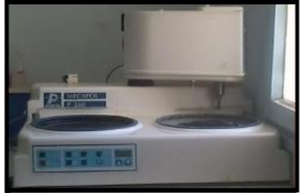
Fig. III.2 : Photo de polisseuse utilisée dans le polissage mécanique
