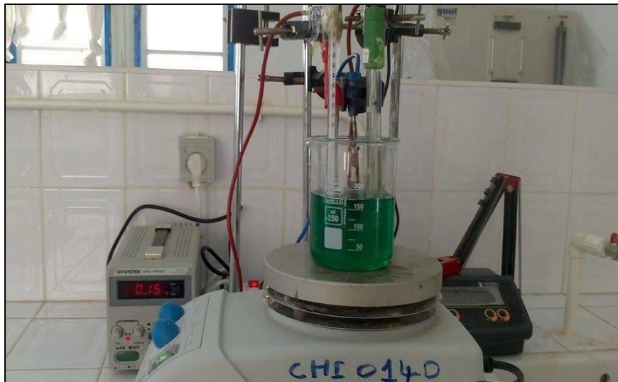
Fig. III.5 : Schéma de montage d'électrodéposition
