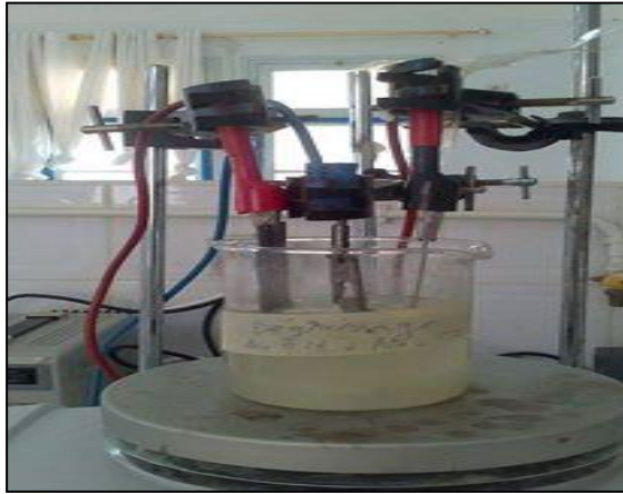
Fig. III.3 : Schéma de montage de dégraissage électrolytique
