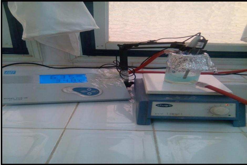
Figure II.4 : Montage de l'extraction liquide-liquide.
