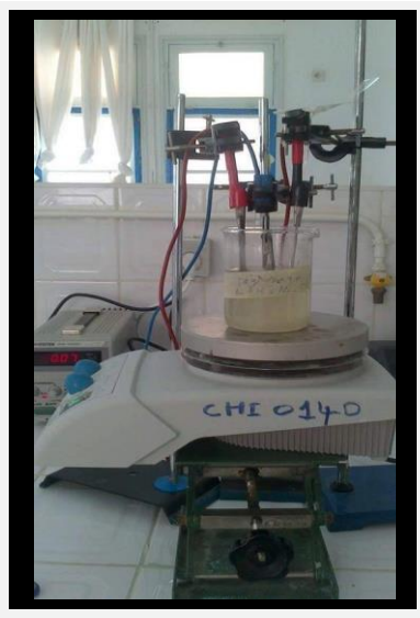
Figure III.2 : Schéma de montage de dégraissage électrolytique.
